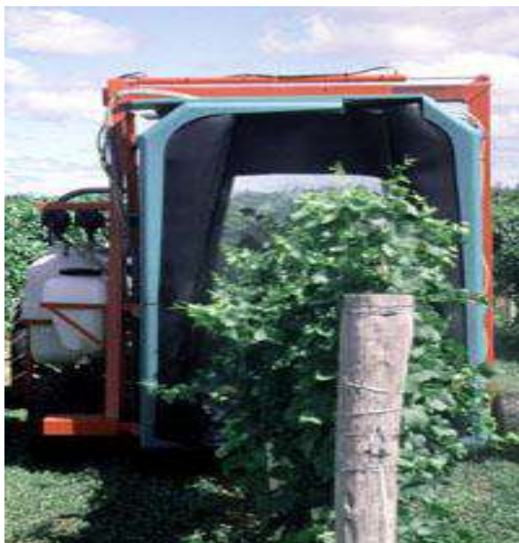
شکل ۶ - نمای یک سمپاش تونلی بازجذبی در حال سمپاشی درختچه های مو.
